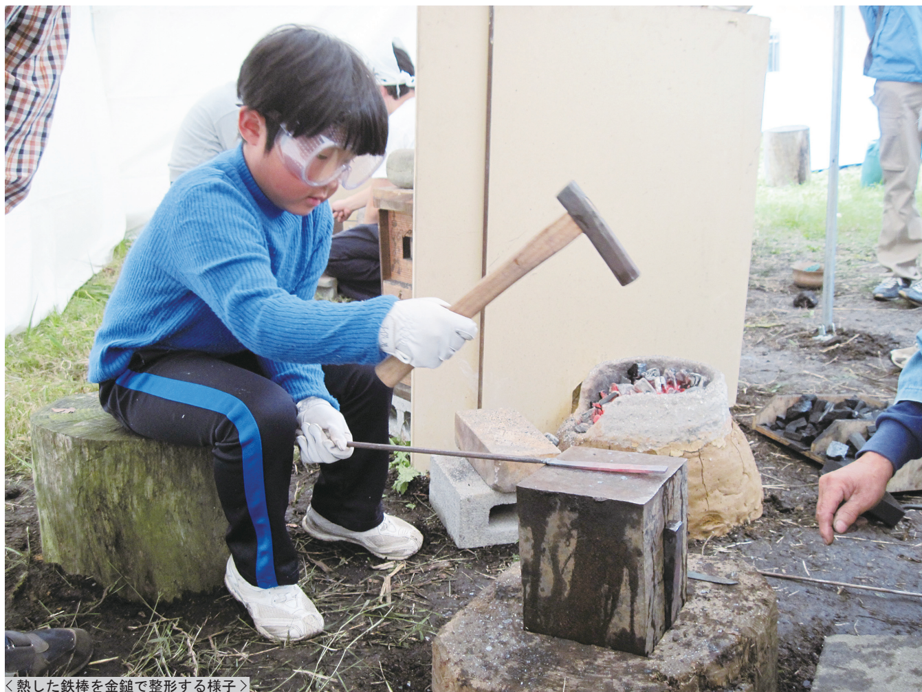
＜熱した鉄棒を金槌で整形する様子＞
