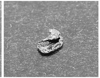
写真5 破損したパイプの一部分 (固定した様子がわかる)
