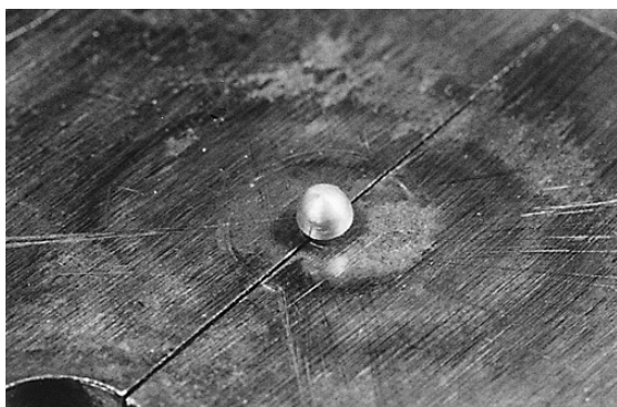
写真9 万力に固定して型鍛造を行う
