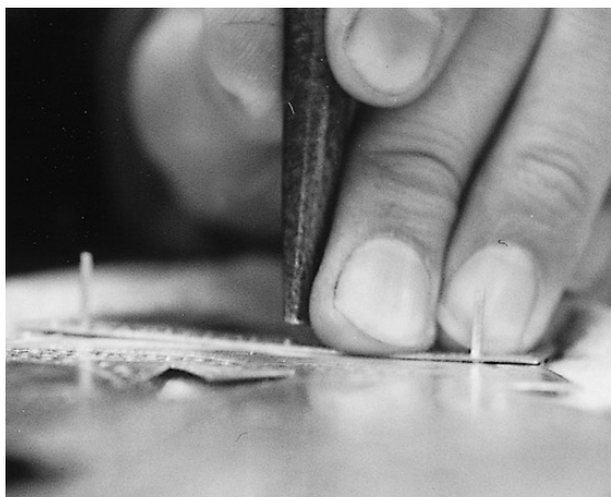
写真12 打ち鑿によるかしめ工程
