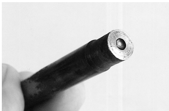
写真8 型鍛造用変形魚々子鑿
