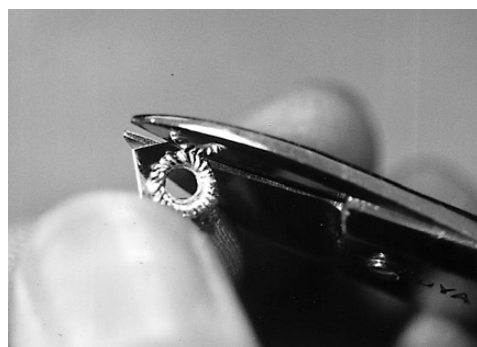
写真15 金鉏で円形に切断する
