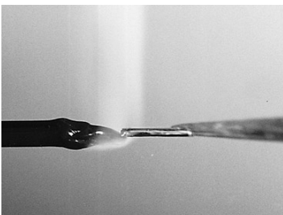
写真23 溶けたガラスをパイプに巻き取る
