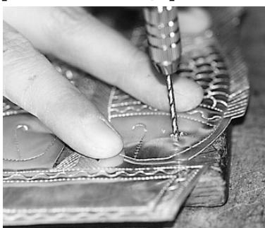
写真26 ドリルで孔加工する
