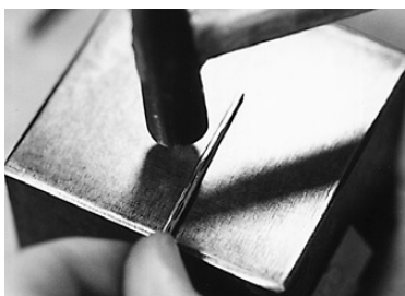
写真20 パイプを回転させながら叩く
