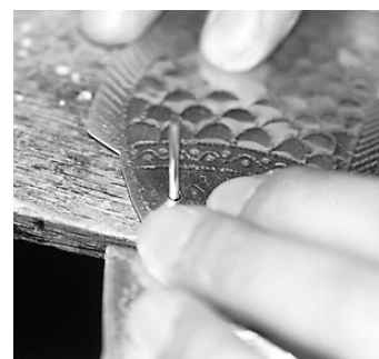
写真27 孔に目玉のパイプを通す
