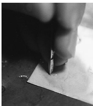
写真7 鉛板上で金銅板に文様を刻む
