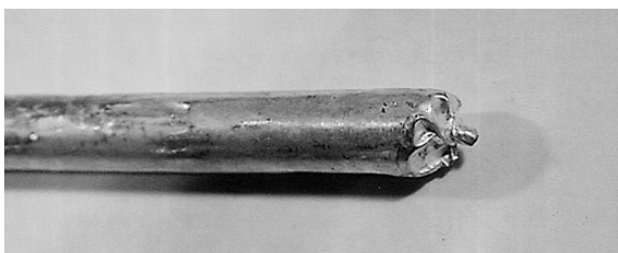
写真10 銀箔の端部固定
