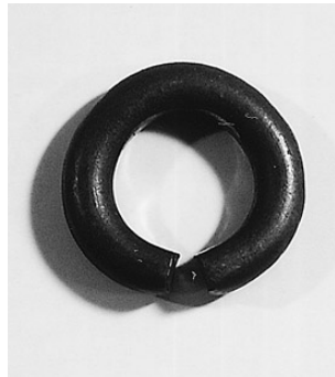
写真2 銅芯切断後、曲げ加工
