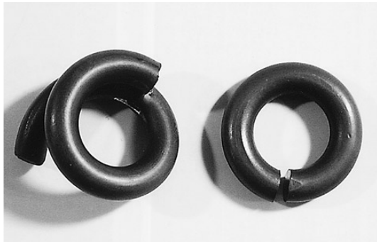
写真1 銅芯のスパイラル状曲げ加工
