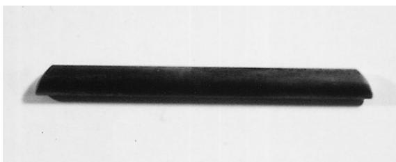
写真8 切断面を斜めに成形
