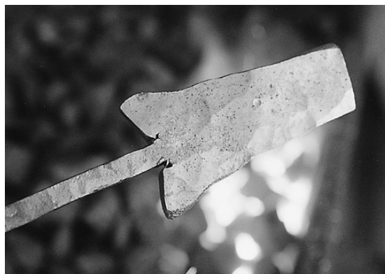
写真6 刃の幅が不足した実験品
