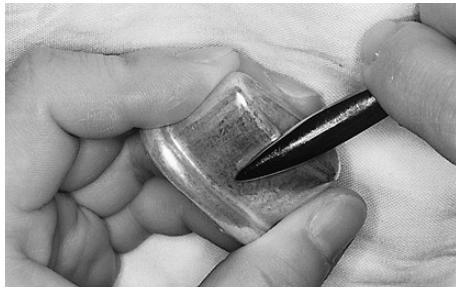
写真9 鉄のヘラでの仕上げ
