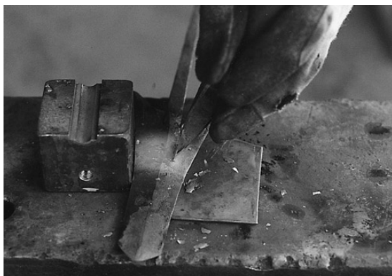
写真22 鋸での切り込み
