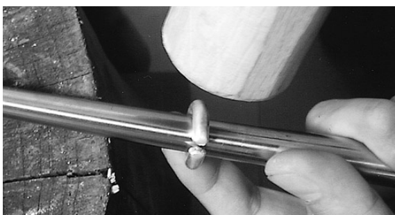
写真12 鉄棒を用いた環状成形
