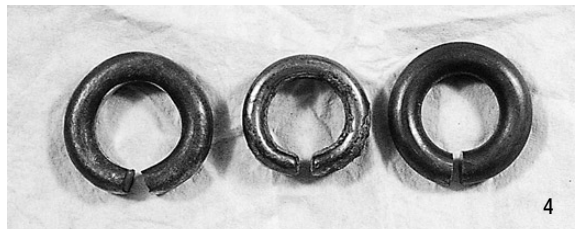
写真2 銅芯切断後、曲げ加工
