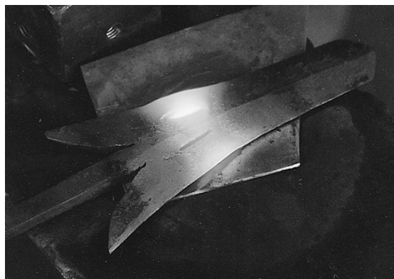
写真23 刃部分に変形が見られる
