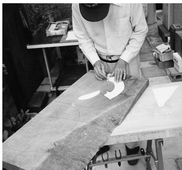
写真3 鞍橋製作ケガキ作業
