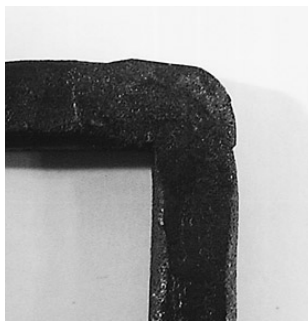
写真2 単純な曲げ加工
