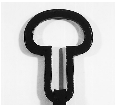
写真9 漆焼きで仕上げた状態
