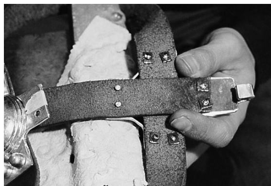
写真11 吊金具部への取り付け
