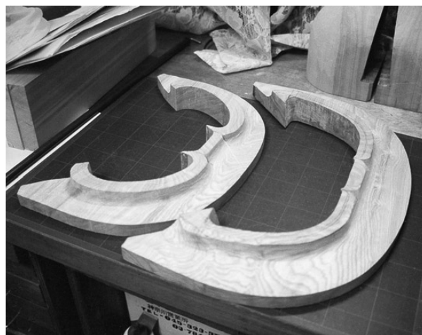
写真3 鞍橋製作ケガキ作業
