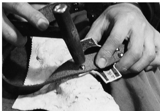
写真10 座金を嵌めた鉄足を金槌で叩いてかしめを行う
