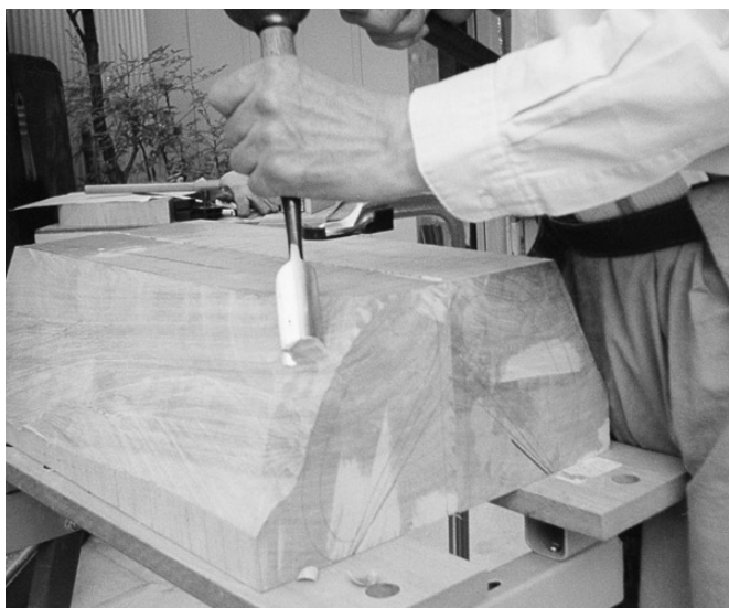
写真8 居木製作 外側加工(3)
