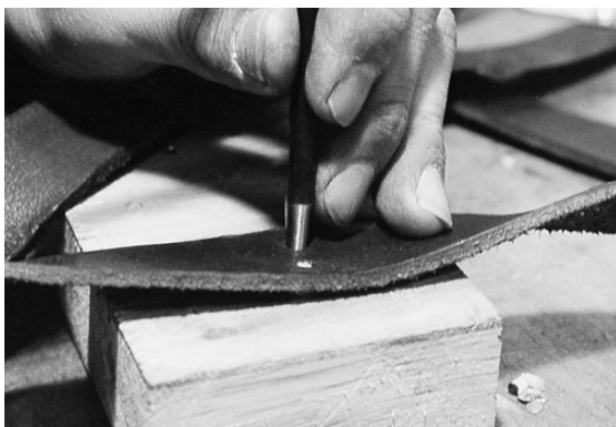
写真7 革帯への孔加工
