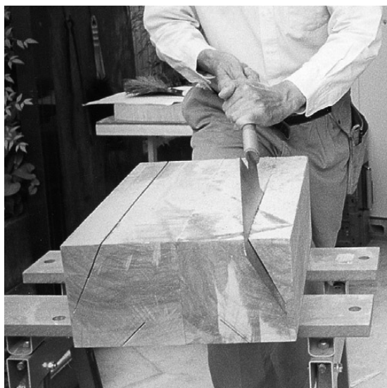
写真7 居木製作 外側加工(2)
