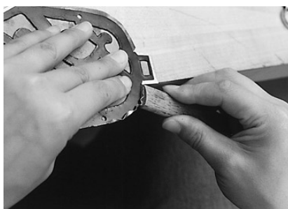
写真52 金銅板を側面に折り返す
