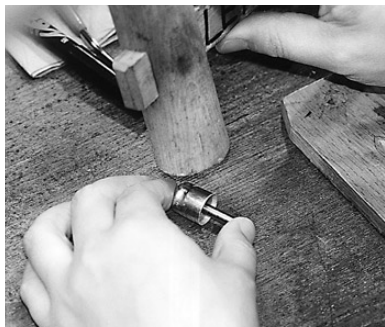
写真158 沈線の押し込み作業
