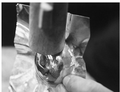
写真136 当て金で半球形の側面を絞る
