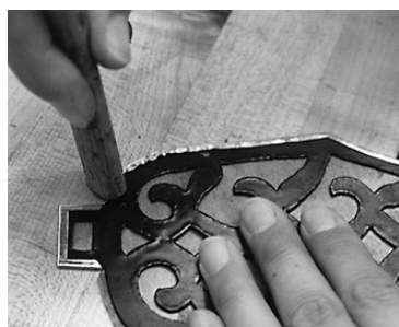
写真53 金銅板を裏面に折り返す
