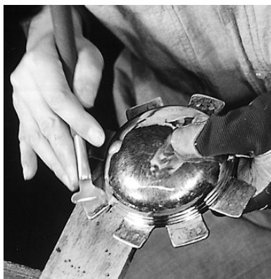
写真112 ヘラで沈線を押さえる
