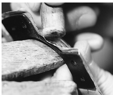
写真142 脚の間の金銅板を延ばす
