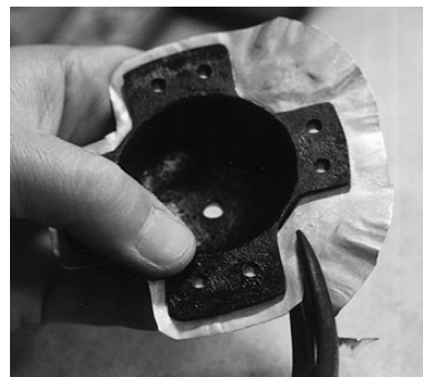
写真141 脚の形に沿って金銅板を切断する
