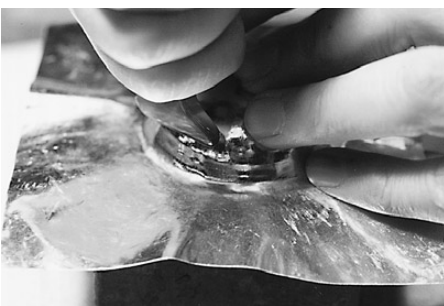
写真137 ヘラで側面を押さえる
