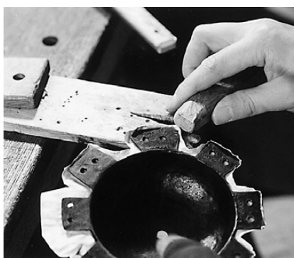
写真103 金銅板を側面に折り返す
