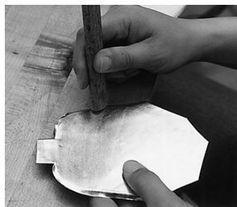
写真51 表から透かし板の文様を写す
