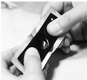
写真63 金銅板を鉄地に馴染ませる
