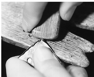
写真80 角は金銅板を寄せて包むように被せる
