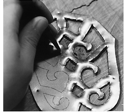
写真36 切断中の透かし板
