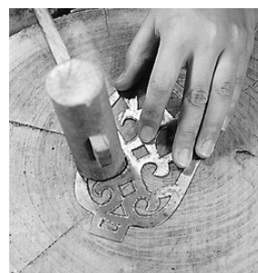
写真9 反った透し板を修正する
