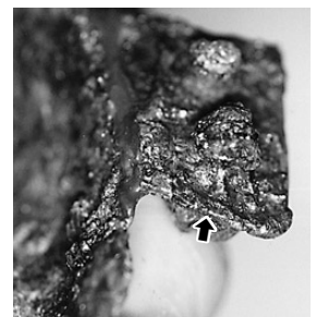
写真18 脚の裏面（折り返しが見える）
