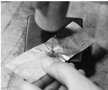
写真67 反った地金を平にする
