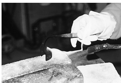
写真31 最後にススを出しながら熱する
