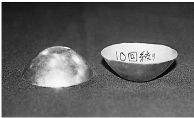
写真151 10回目の絞り加工
