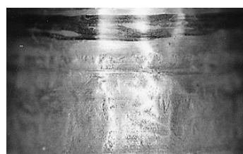
写真24 表面に残った鋳目
