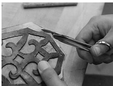
写真46 余分な地金を切り落とす
