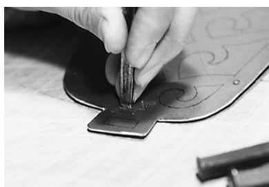
写真5 鑿を使用して櫛木口面上で切断する
