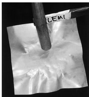
写真87 裏側から打ち出す
