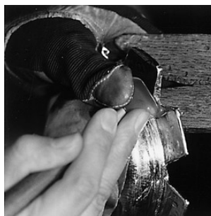
写真110 ヘラで金銅板を側面に倒す
