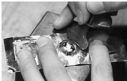
写真70 ヘラで金銅板をさらに密着させる
