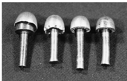
写真170 鉄頭に金銅板を被せる工程
