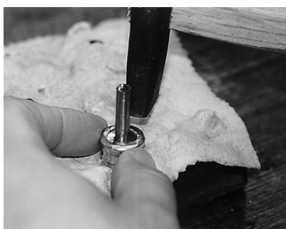
写真160 金錘で打って固定する
