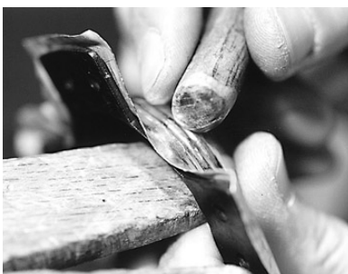
写真143 鉄地に沿って金銅板が延びる
