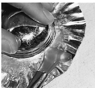
写真139 ヘラで沈線押し込む
