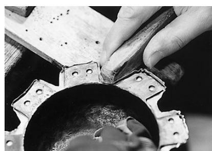
写真106 金銅板を脚の側面に折り返す
