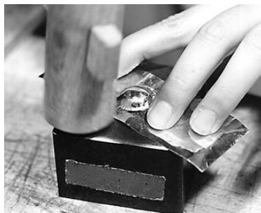
写真68 鉄地に金銅板を被せて叩く
