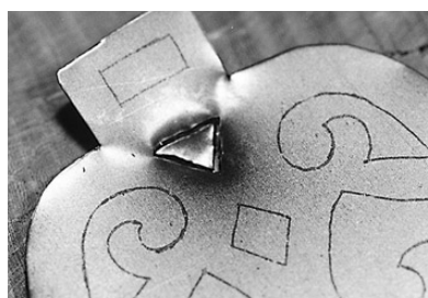
写真6 切断鑿で透かす（表面）
