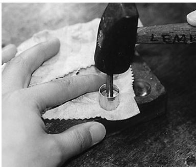
写真157 鉛台で鉄地の頭を打ち込む
