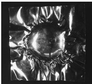
写真88 表側から木槌で叩き、鉄地の形に沿わせる
