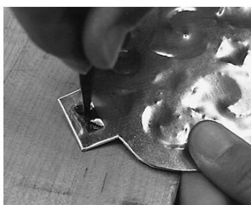
写真55 孔の中の金銅板を鑿で切断する
