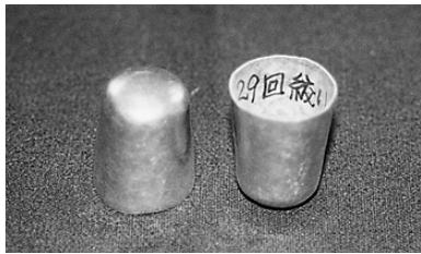
写真155 29回目の絞り加工
