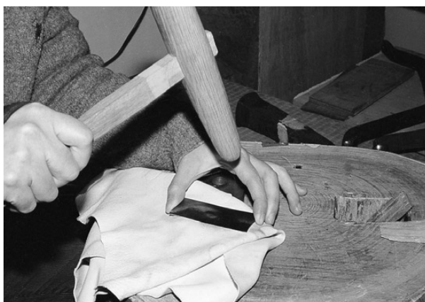
写真5 鉄板を木槌で軽く打出す。
