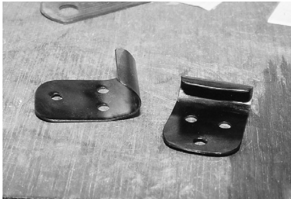
写真1 曲げた状態で漆焼きをする。
