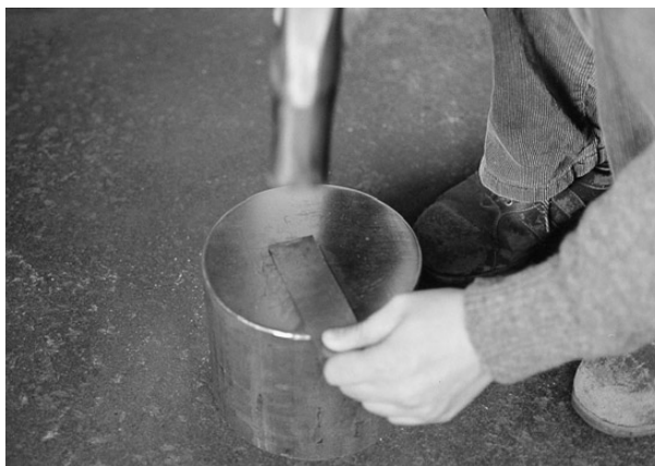
写真3 0.71ミリの鉄板を打ち延べる。
