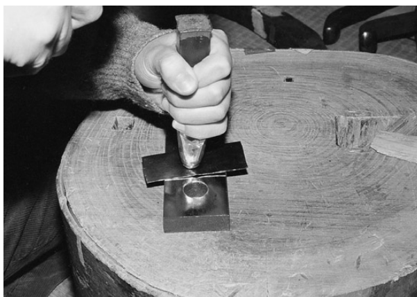
写真7 鉄製の鑿で打出す。
