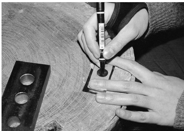
写真4 打出しの位置を鉄板の裏面に印す。
