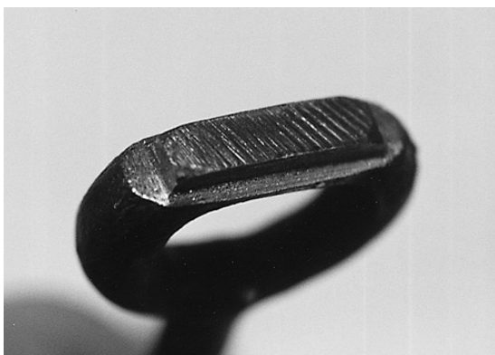
写真11 銚端部の削り出し
