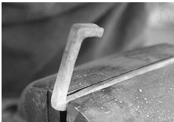
写真19 鍛接部の曲げ加工②
