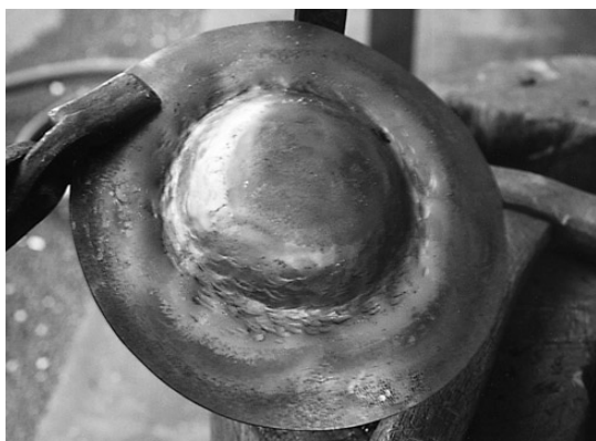
写真17 本体半球形部分の絞り加工
