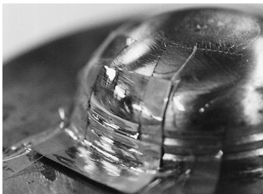
写真23 銅板を被せた状態で形状の確認を行う
