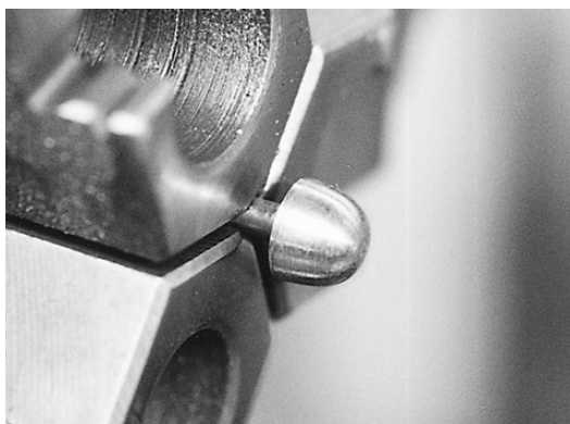
写真9 鋇頭部の曲面切削
