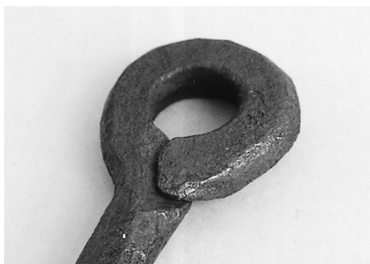
写真6 重ねた部分に段差が見える
