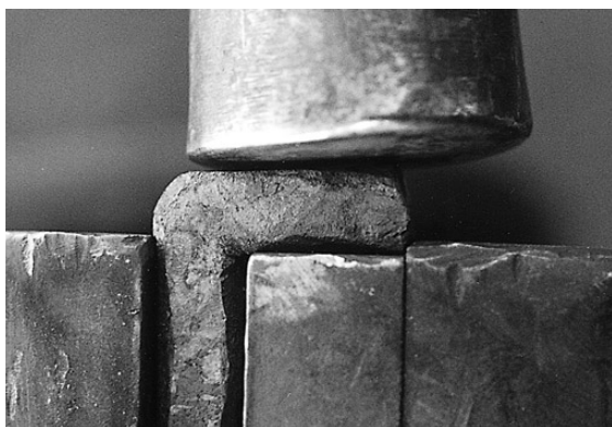
写真17 角部分の据込み加工
