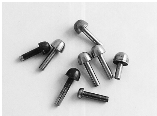
写真12 鋇頭部を研削して完成
