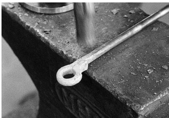
写真31 鍛接部の整形
