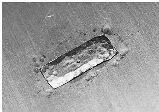
写真48 かしめ加工をした箱形リベットの先端部
