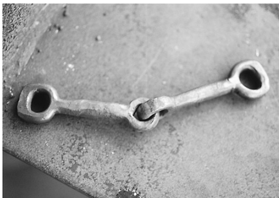
写真38 鍛接部分の整形を終えた状態
