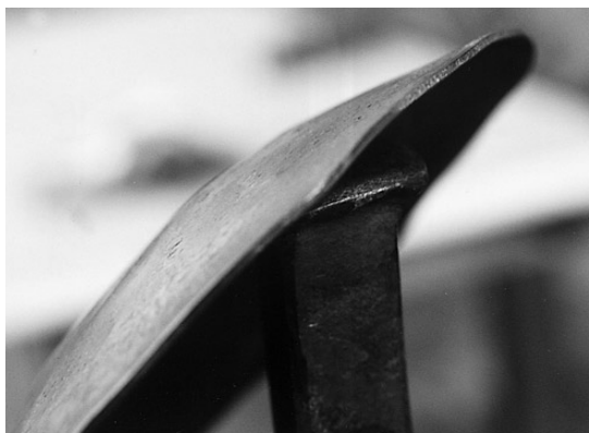
写真14 素材の鋼板と当金
