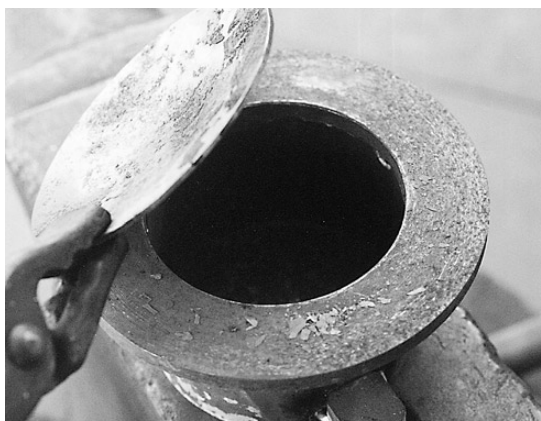
写真7 脚部分の鍛造用沿わせ型
