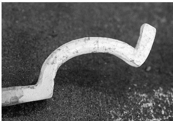
写真21 輪環部の曲げ加工
