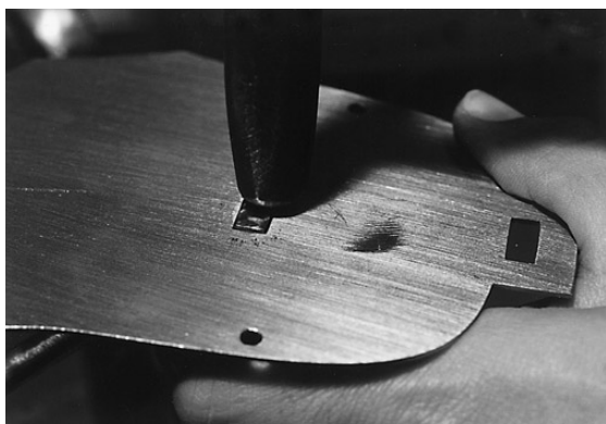
写真47 金槌によるかしめ加工
