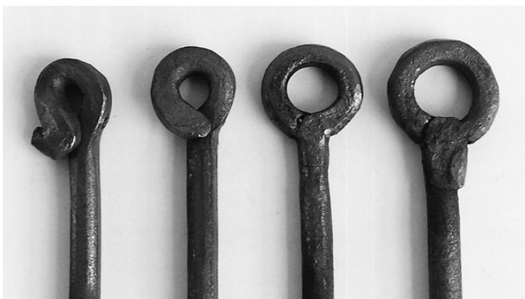
写真7 重ねて鍛接を行った実験品
