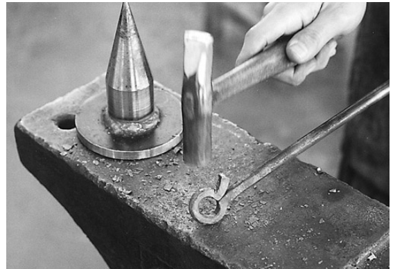
写真24 接合面の位置を修正する
