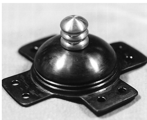
写真31 漆による焼き付けを終えた状態
