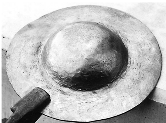
写真19 脚部分を平らに整形する
