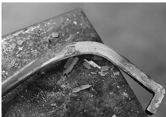
写真18 鍛接部の曲げ加工①
