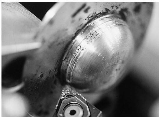
写真21 旋盤による沈線の加工
