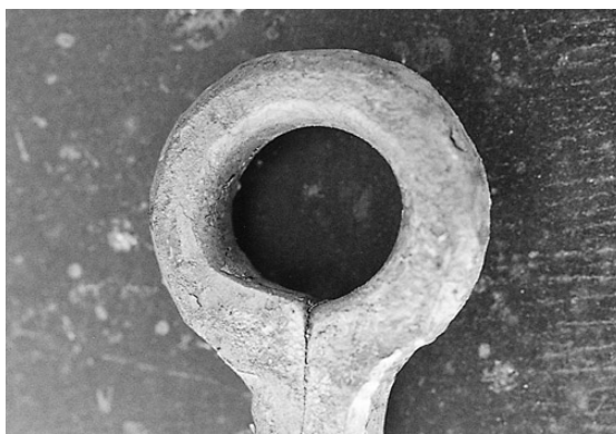
写真32 中央の隙間は以降の工程で修正を行った
