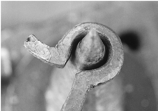
写真23 円錐形の金型での曲げ加工②
