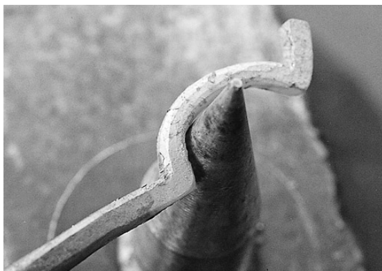
写真22 円錐形の金型での曲げ加工①
