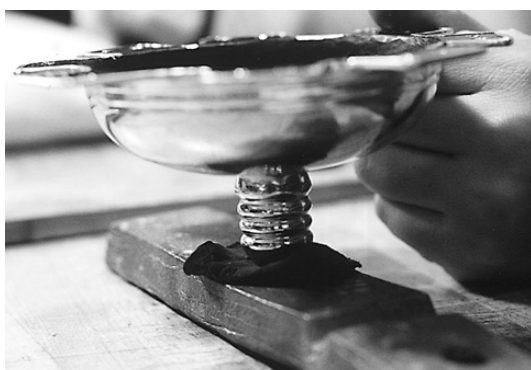
写真34 鉛台の上に固定する
