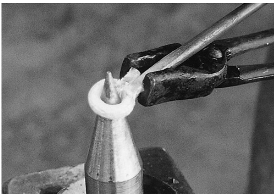
写真25 接合面の仮合わせ
