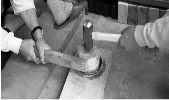
写真 14 大鈴の打ち出し作業
