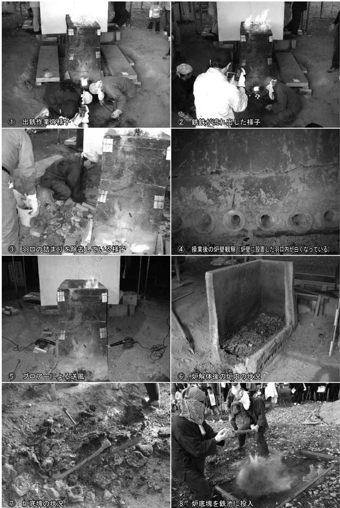
写真5 操作及び炉解体の様子
