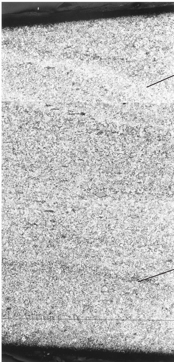
写真 37 資料 No. 5 の C 断面組織写真 × 100
