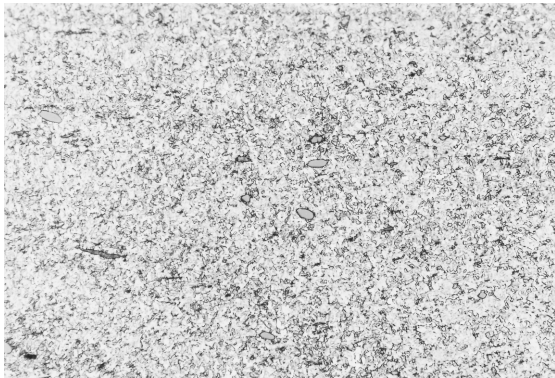
写真 38 資料 No. 5 C 断面鉄組織写真 × 100 (1)
