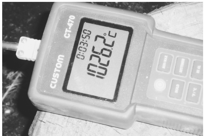
写真 12 鍛冶炉内の温度
