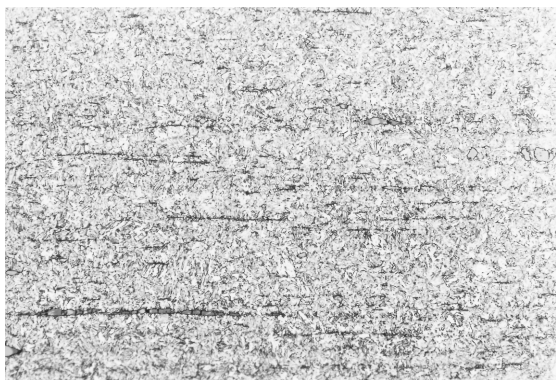
写真 42 資料 No. 5 L 断面鉄組織写真 × 100 (1)
