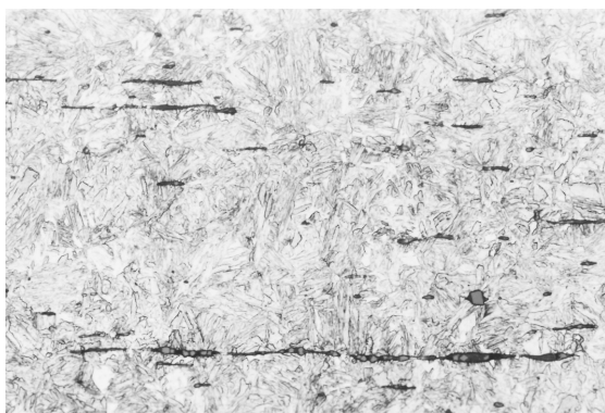
写真 44 資料 No. 5 L 断面鉄組織写真 × 100 (2)
