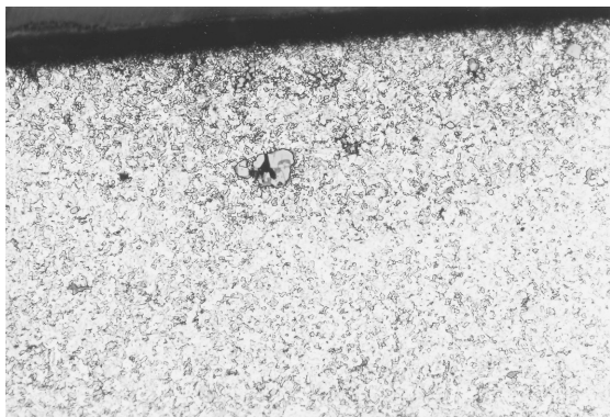
写真 40 資料 No. 5 C 断面鉄組織写真 × 100 (2)
