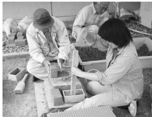
ブロックの木枠 (内寸：幅11×長19×深7.5cm)
