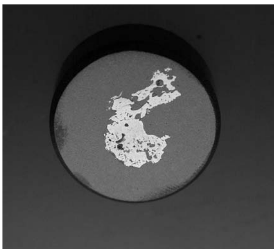
写真 25 埋め込み資料 (NO. 7)
