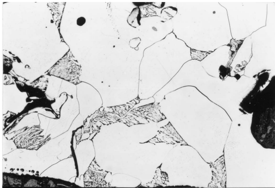
写真 61 鉄組織写真 (資料 NO. 7-2) × 100
