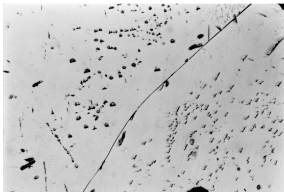
写真 56 鉄組織写真 (資料 NO. 3-1) × 400
