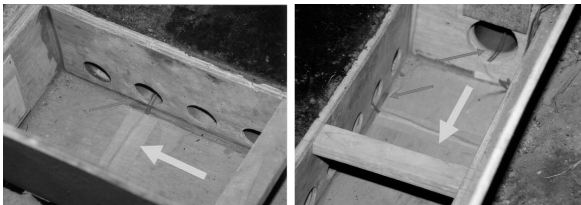
写真2 風箱内での圧力センサーの設置位置 (太い矢印が風の方向、細い矢印がセンサの設置位置)
