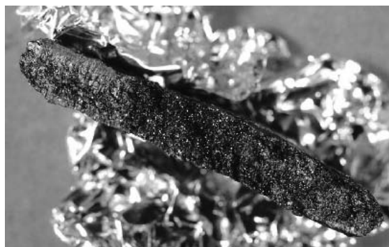
図 11 梵鐘 3 の堰の破面
