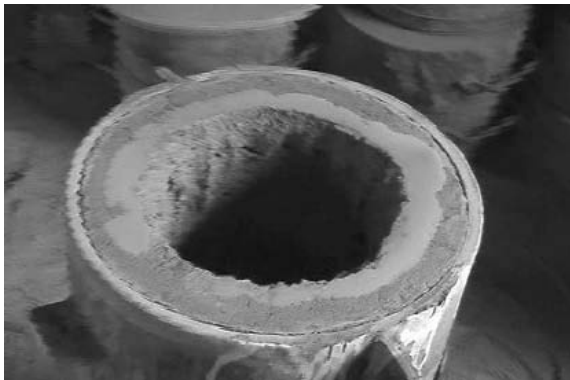
図 21 外型に真土を込めて中子を作る
