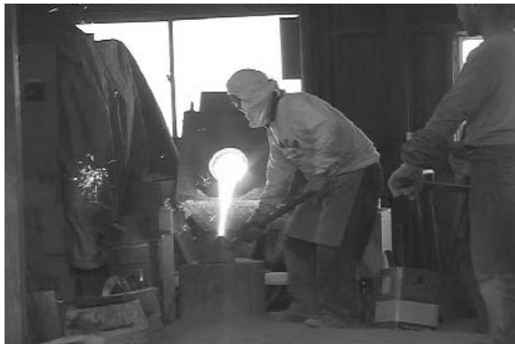
図 29 溶けた鉄をとりペに取る
