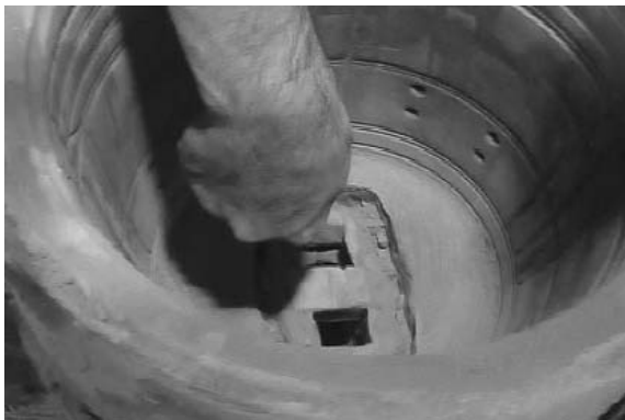
図 23 外型に竜頭の鑄型を埋け込む
