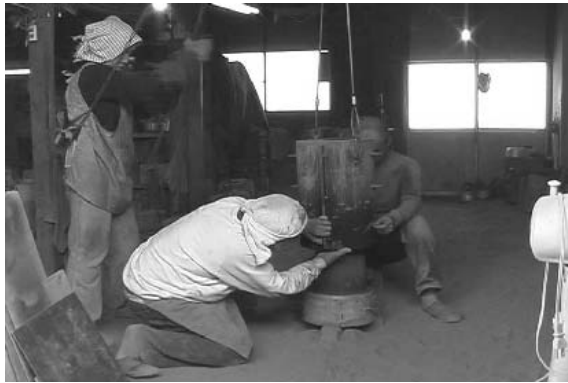
図 27 鑄型を組み上げる
