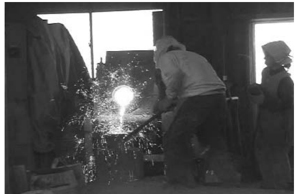
図 30 カーボンボイリングが激しい
