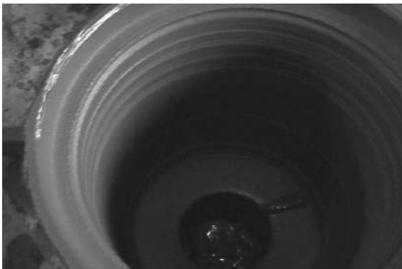
図 17 仕上げ真土を挽き終わった
