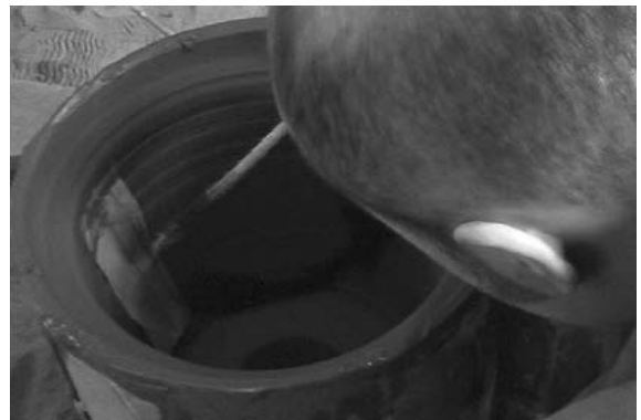
図 18 縦方向の袈裟襷を書いた薄紙を貼る
