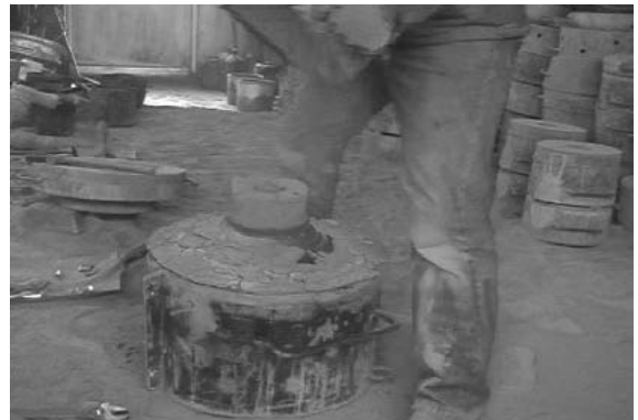
図 61 鋳型から製品を取り出す（1）
