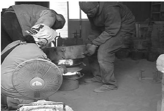
図 97 鑄型に煤を付け
