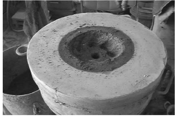
図 91、92 中子の内側に凹凸をつける
