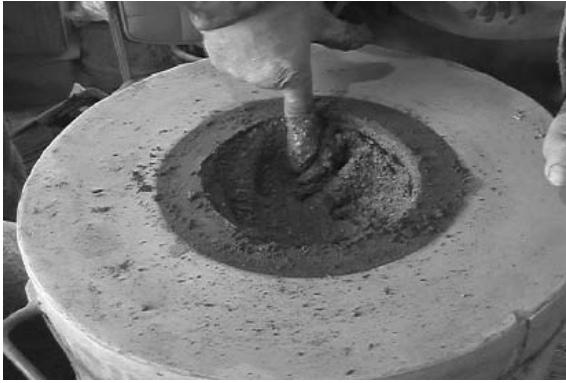
図 91、92 中子の内側に凹凸をつける
