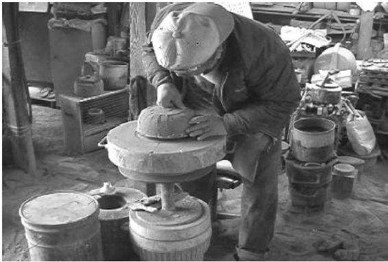
図 93、94 中子を取り出し、はばきに貼り付け、乾燥させて、黒味（離型剤）を塗る
