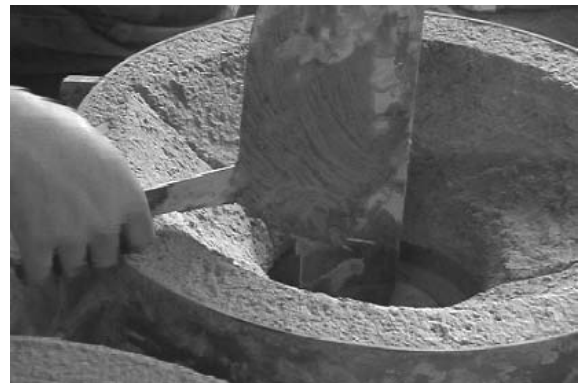
図 11、12 「うま」と「とりめ」で挽き型を固定する
