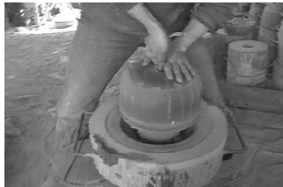
図41, 42 底型の中子を底型から抜き、甲型の中子に貼り付け、抜く
