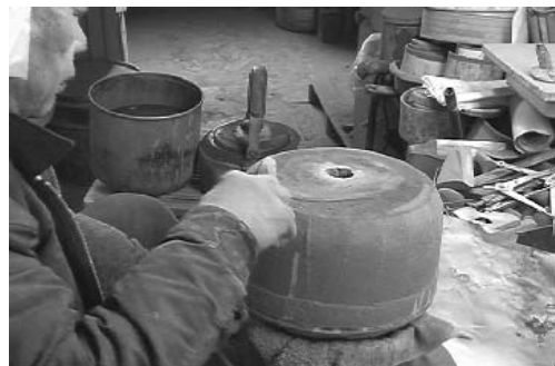
図45 中子の表面を削り取る
