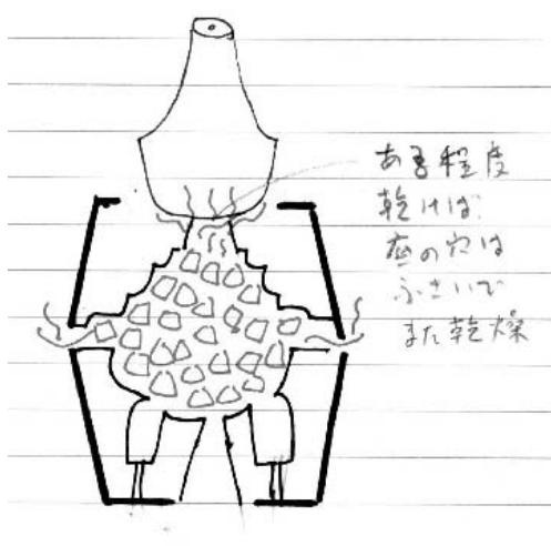
図 48 中子、甲型、底型全てを炭火で乾燥させる
