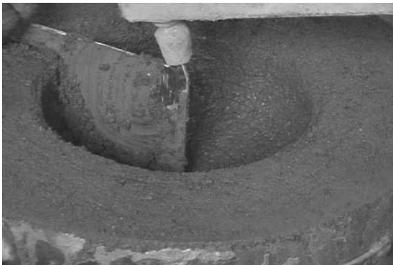
図 83、84 第二層の中真土を挽く
