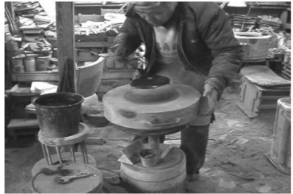
図 93、94 中子を取り出し、はばきに貼り付け、乾燥させて、黒味（離型剤）を塗る
