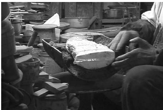
図 66、67 荒真土の充填
