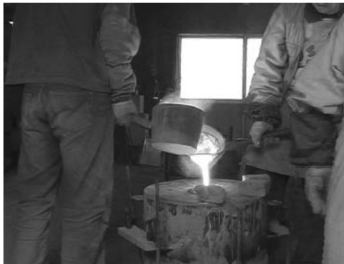
図 60 とりべからとりべへ湯を継ぎながら鋳込む
