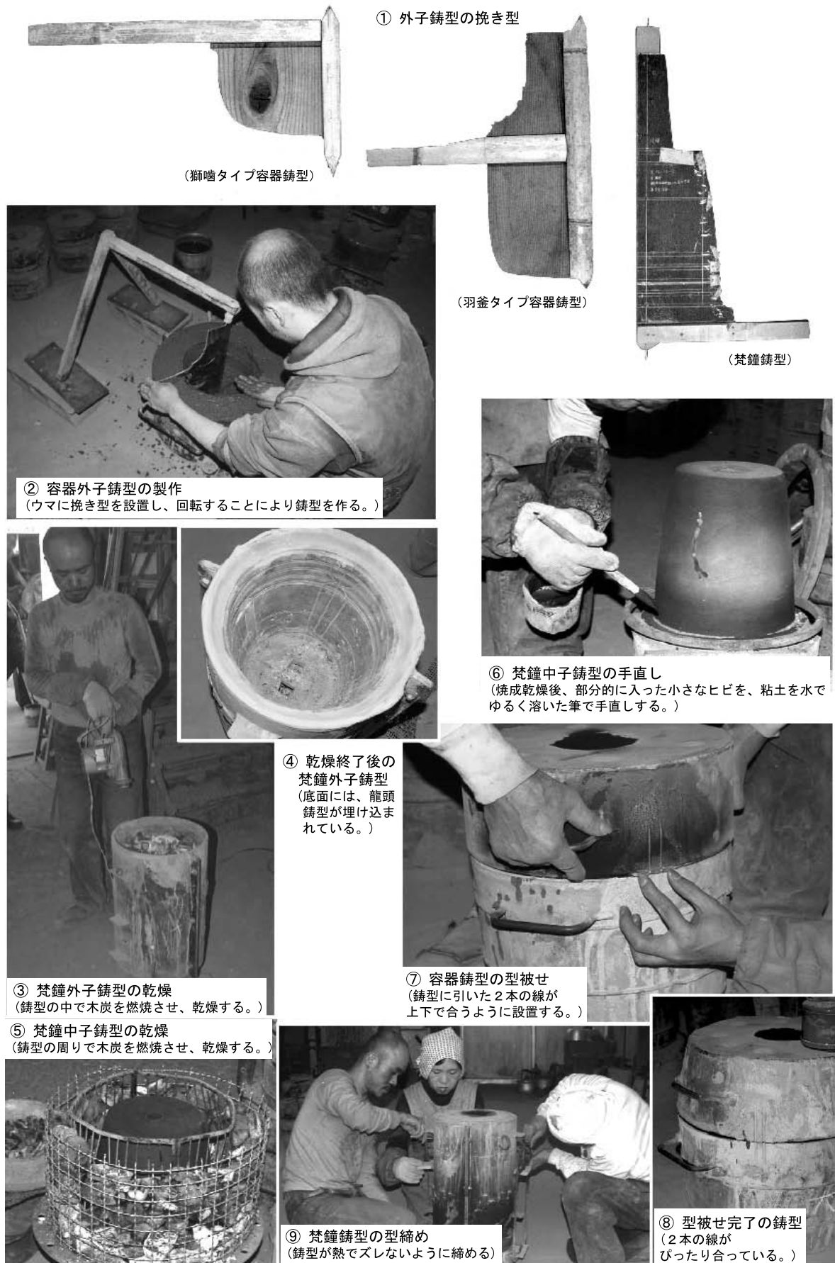
写真3 鑄型製作から鑄型設置
