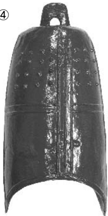
2号風鐸(乳付き)1回目鋳込み →赤漆塗り仕上げ 原料：玉鋼30%+鉄鉱石ズク70%
