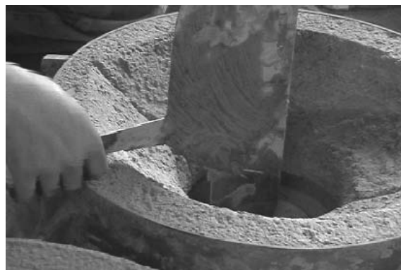
図 11、12 「うま」と「とりめ」で挽き型を固定する
