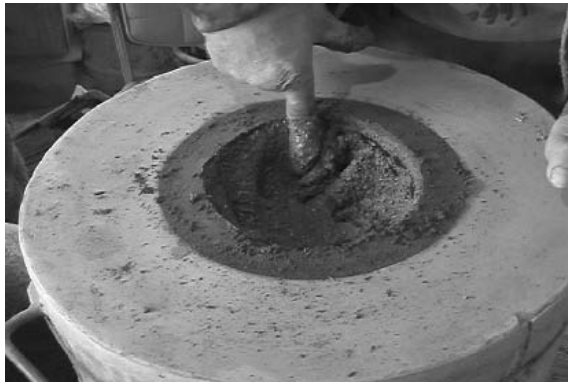
図 91、92 中子の内側に凹凸をつける
