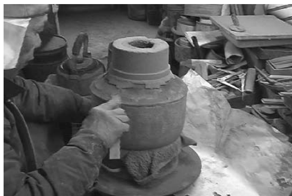
図 46.47 中子の表面を削り取る
