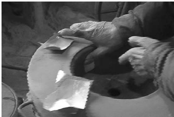
図 85、86 獣脚の鑄型を埋け込む孔の上部に紙を充てて補強
