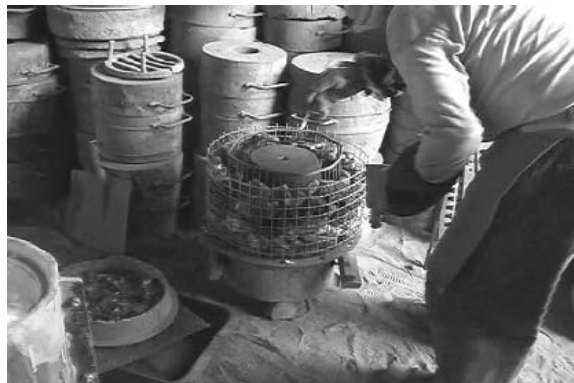
図 24 中子を焼成し乾燥させる
