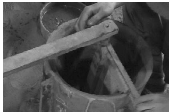
図 16 挽き型を使って真土を挽く
