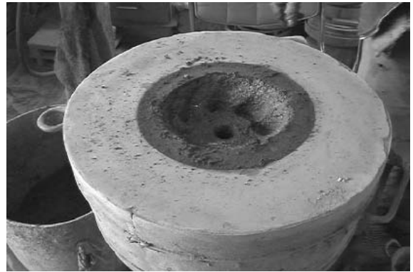
図 91、92 中子の内側に凹凸をつける
