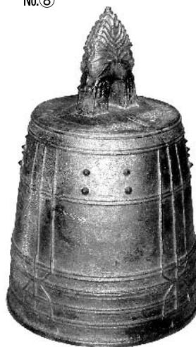
梵鐘2回目鋳込み→仮称稻藁燻し法 原料：玉鋼50%+鉄鉱石ズク50%
