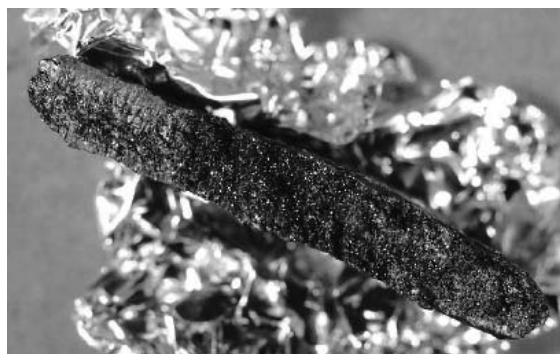
図 11 梵鐘 3 の堰の破面
