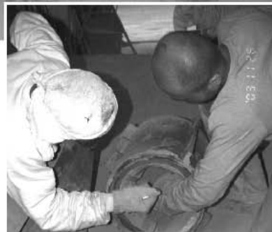
④ 中子をばらす (鑄込み終了後、収縮によるひび割れを防ぐため、すぐさま中子はずす。まだ、製品は熱く、赤々としている。)
