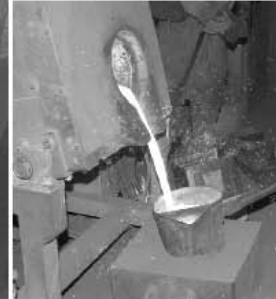
② 溶けた湯を杓で受ける (湯の周りには、カーボンボイリング現象により火花が飛び散る。下は別角度からのアップの写真。)
