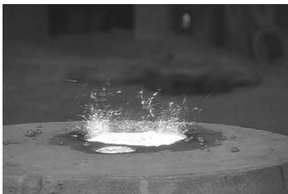
図 33 鑄込み直後（カーボンボイリングが残る）
