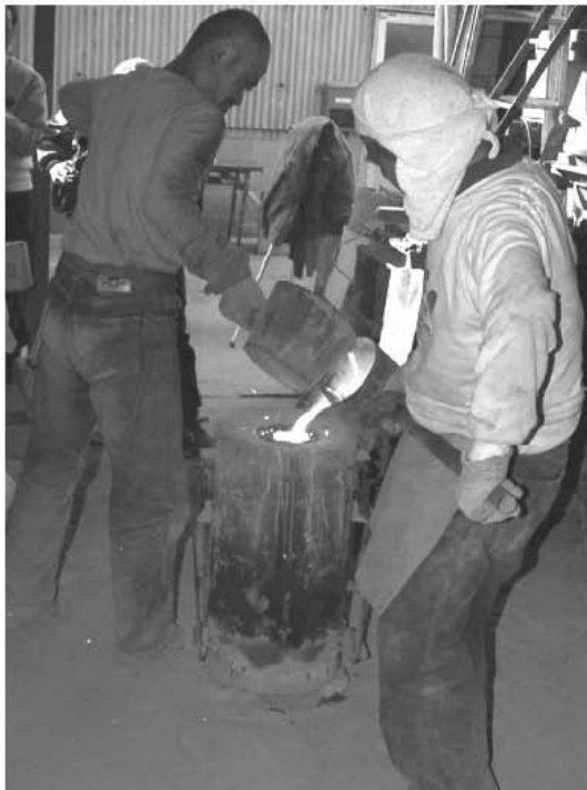
③ 鑄込み状況 (梵鐘の鑄込み。もっとも緊張する一瞬。鑄型に流す杓からの鑄込みが途絶えないように、杓から杓に湯を足す。)
