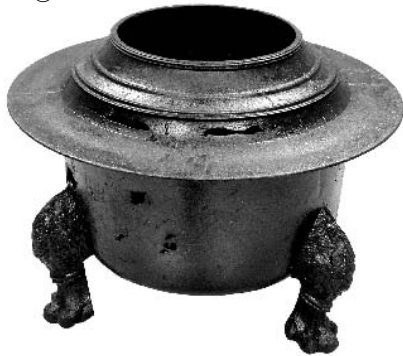
獸脚付容器(羽釜タイプ) 1回目鋳込み→油焼き法 原料：玉鋼30%+鉄鉱石ズク70%
