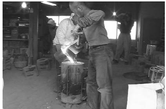
図 32 溶湯の不足を2つ目のとりペで補う
