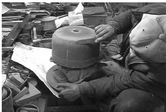
図 46.47 中子の表面を削り取る
