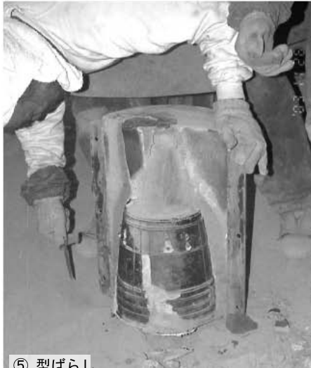
⑤ 型ばらし (外子はずす。右はそのアップ写真。鑄込口のセキと、ガス抜き穴から上がった湯が見える。)
