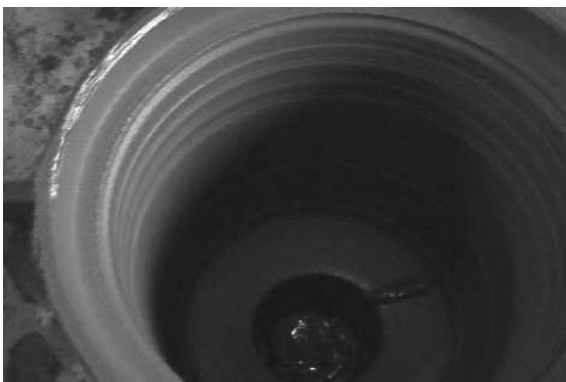
図 17 仕上げ真土を挽き終わった
