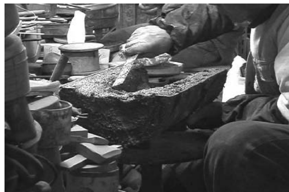
図 66、67 荒真土の充填
