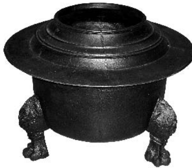
獸脚付容器(羽釜タイプ) 2回目鋳込み→漆焼き法 原料：玉鋼50%+鉄鉱石ズク50%
