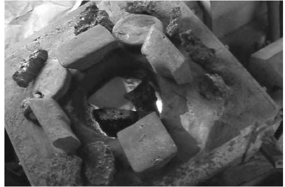
図 57 ズクの溶解（電気炉による）
