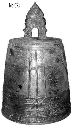
梵鐘1回目鋳込み→仮称炭焼き法 (蜜蝋仕上げ) 原料：玉鋼100%
