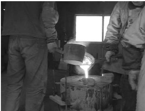
図 60 とりべからとりべへ湯を継ぎながら鑄込む
