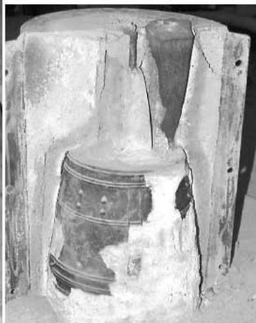
⑤ 型ばらし (外子はずす。右はそのアップ写真。鑄込口のセキと、ガス抜き穴から上がった湯が見える。)
