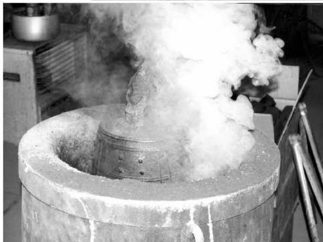
③ 仮称稻藁燻し法 (稻藁を低温で燃やし、その煙でコーティングする。)
