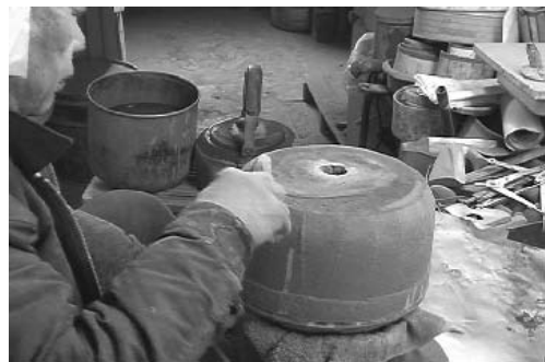
図45 中子の表面を削り取る
