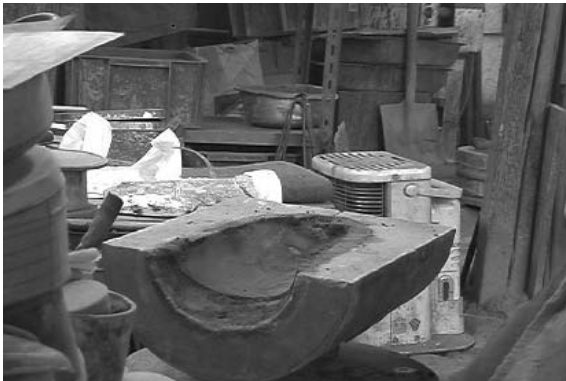
図 70 中真土の充填が終了
