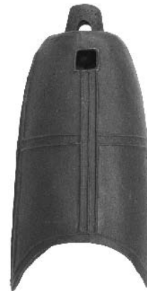
1号風鐸(乳なし)→漆焼き法 原料：玉鋼50%+ 鉄鉱石ズク50%
