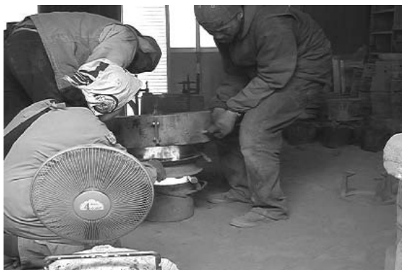
図 97 鑄型に煤を付け
