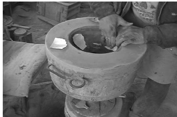
図 85、86 獣脚の鑄型を埋け込む孔の上部に紙を充てて補強
