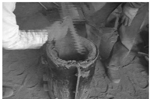
図 34 製品の取り出し（中子から壊していく）
