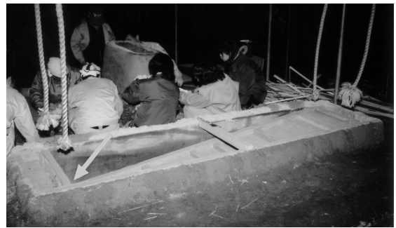
写真3 踏み鞆の外観と圧力センサーの設置位置
