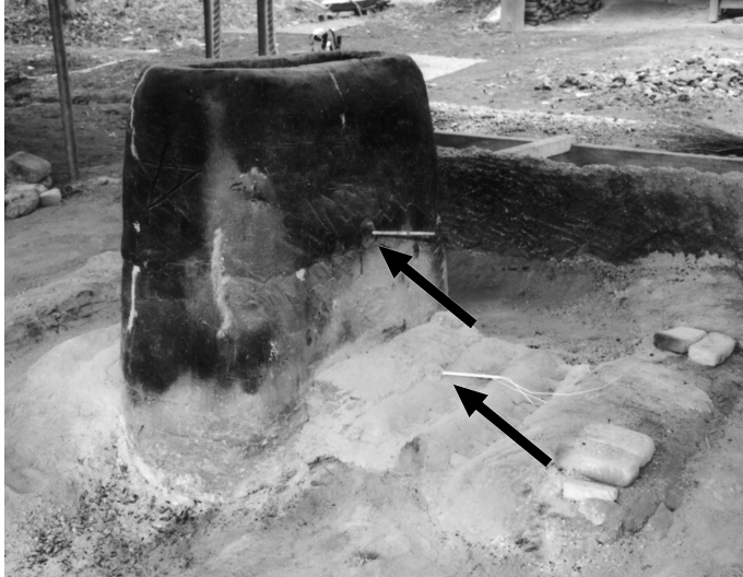
写真1 炉の外観と熱伝対の設置位置
