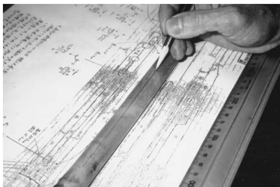
写真8 寸法図を基に各孔の位置を決める
